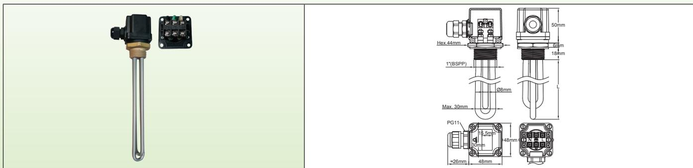
**Applications principales :** Chauffage de liquides, circuits d'eau chaude sanitaire, ballons tampons et réservoirs. Comporte 2 éléments chauffants dia 8mm 230V raccordés en parallèle. Le montage de ces éléments en série permet l'utilisation en 115V. **Ces modèles sont les plus petits des thermoplongeurs à résistance épingle avec boîtier de raccordement. Ils comportent un bornier incorporé facilitant le raccordement. Leur petite taille ne permet cependant pas d'y incorporer un thermostat.**
